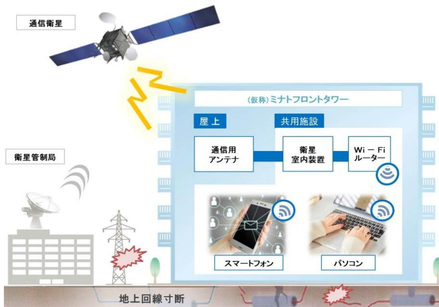
衛星インターネットは、赤道上の高度 36,000km に打ち上げられた人工衛星と、パソコンやスマートフォンのような通信機器が直接インターネットアクセスを行うものです。通信規制や回線混雑といった地上の影響を受けないため、災害時でも「つながる通信手段」として、官公庁やインフラ系の民間企業において数多く採用されています。
